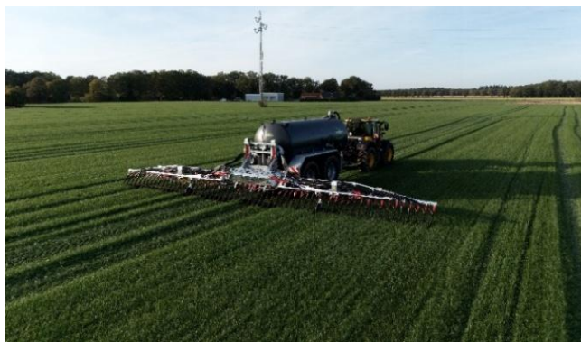
Bild 2: Mit den Schleppschuhgestängen der BlackBird-Serie können Anwender die Gülle präzise und bodennah ausbringen (im Bild: das Modell BlackBird Pro).
