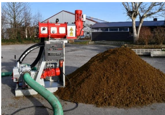
Bild 1: Der XSplit Compact vereint Separations-, Pumpen- und Steuerungstechnik in einer kompakten Einheit.
