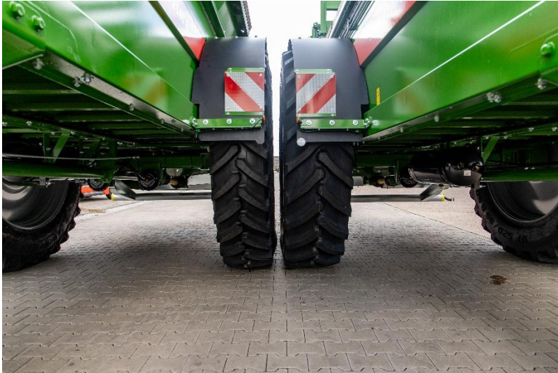
Bild: Gegenüberstellung der beiden Bereifungen mit EU-Typgenehmigung (CoC): links der VF 480/95 R50, rechts der neue VF 520/85 R50 .
