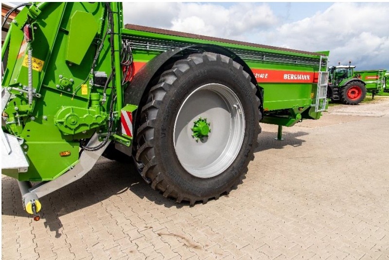
Bild: Der Tiefbett-Universalstreuer TSW 2140 mit der neuen Bereifung VF 520/85 R50 Trelleborg TM 150 TL 177 D .
