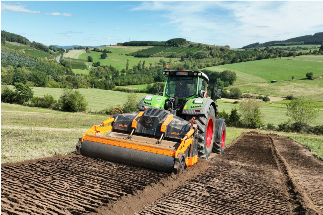
Bild 1: Die Forst- & Rodungsfräse ist für Schlepper ab 260 PS ausgelegt
