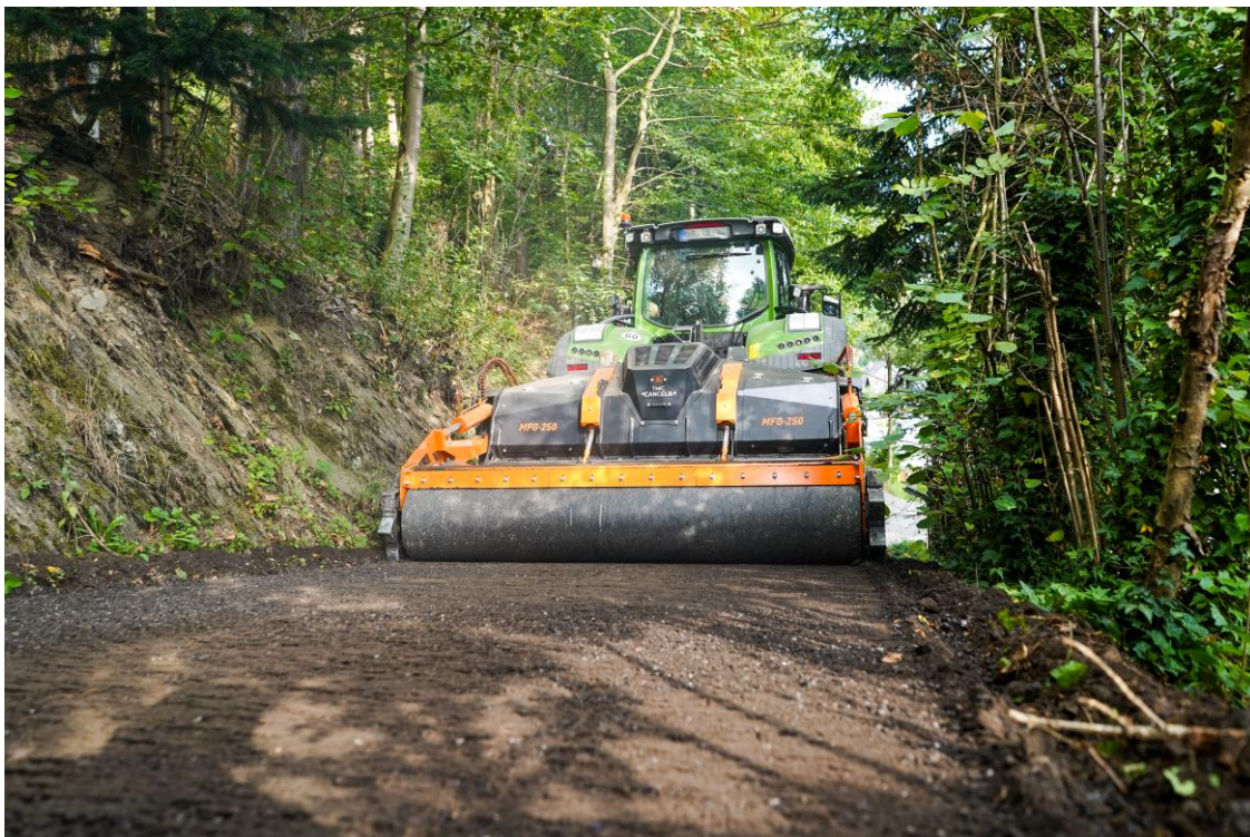
Bild 2: Die Fräse kann sowohl im Forst als auch im Wegebau eingesetzt werden
