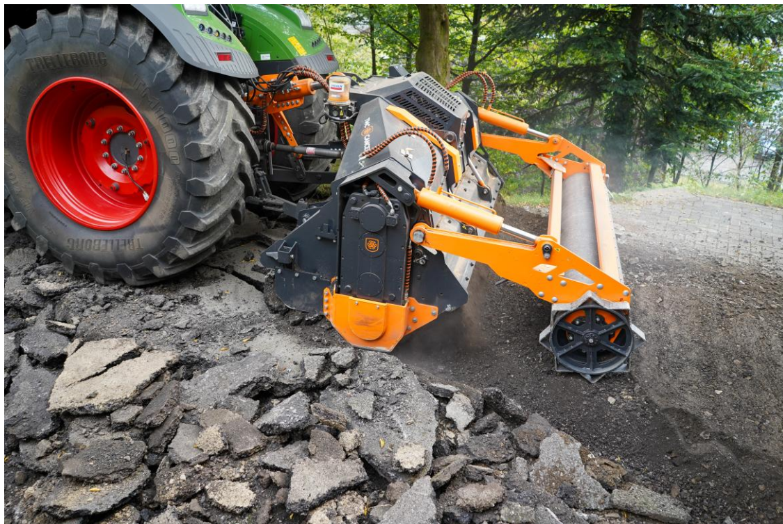
Bild 4: Auch das Auffräsen von Asphalt ist für die MFG kein Problem
