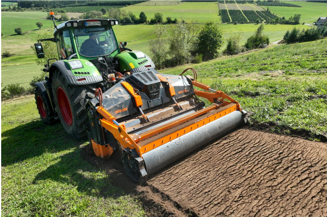
Bild 3: Die MFG erreicht eine Arbeitstiefe bis zu 40 cm unter Bodenniveau
