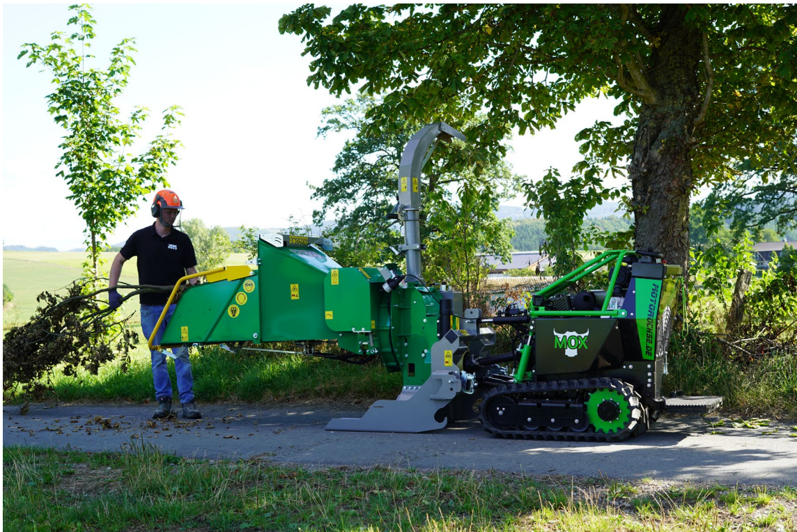
Bild 3: MOX mit Forstmulcher, der auch als Forstfräse & Steinbrecher nutzbar ist
