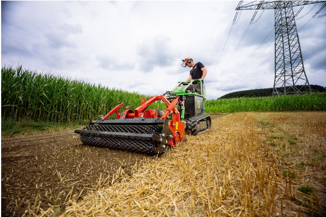
Bild 2: MOX + Umkehrfräse für die Bodenbearbeitung
