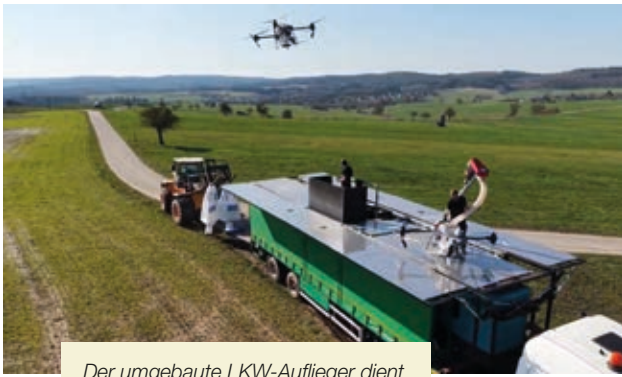
Der umgebaute LKW-Auflieger dient als Landeplatz und als Transport für Düngemittel.
