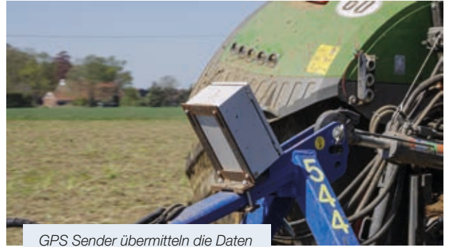
GPS Sender übermitteln die Daten an Agrarmonitor
