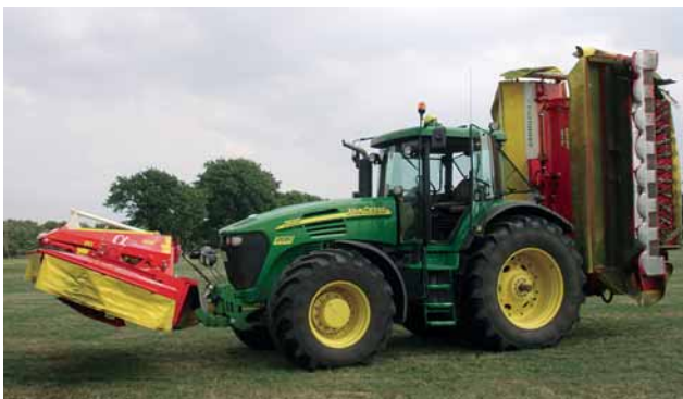
■ Mit schweren Anbaugeräten sind die Achslasten und das zulässige Gesamtgewicht zu berücksichtigen. Das Maß von Lenkradmitte nach vorn soll 3,5 m nicht überschreiten. Bei mehr als 3,5 m ist ggf. ein Einweiser erforderlich, 35. Ausnahmeverordnung.
