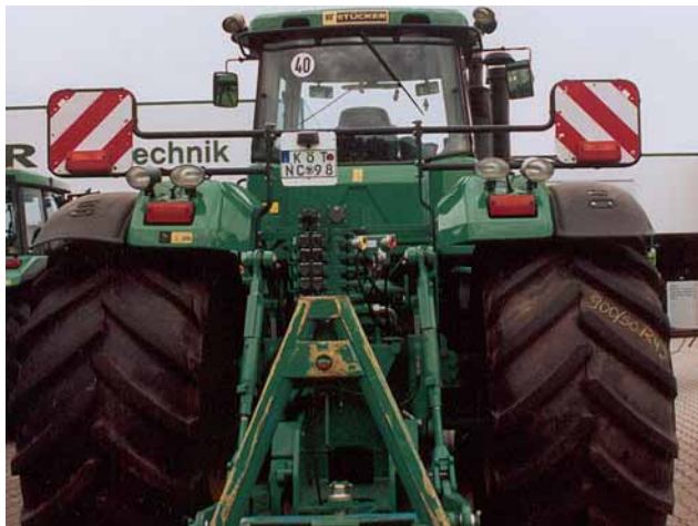
■ Traktor vorn und heckseitig mit 900 mm Breitbereifung. Die Breite von 3 m wird eingehalten.
