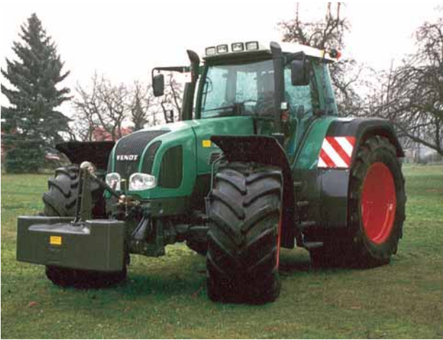
■ Traktor vorn und heckseitig mit 900 mm Breitbereifung. Die Breite von 3 m wird eingehalten.
