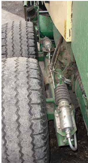
■ Automatisch lastabhängiger Bremskraftregler (ALB).
