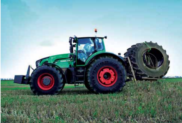
■ Transport der Außenräder in der Heckhydraulik des Traktors (Twin Räder Grasdorf Wennekamp GmbH)
