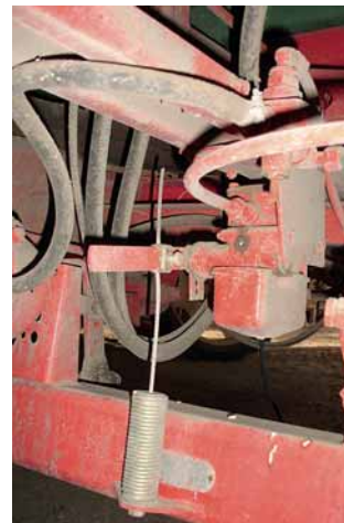
■ Automatisch lastabhängiger Bremskraftregler (ALB).
