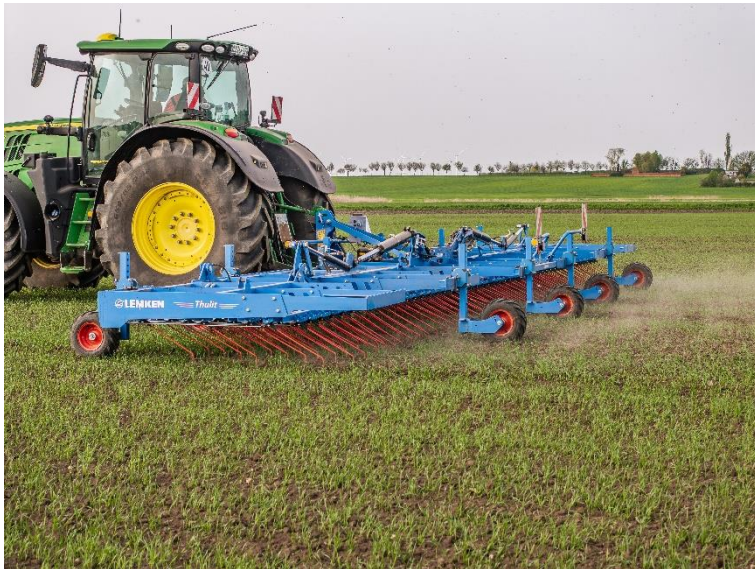
Bild 2: Der LEMKEN Thulit arbeitet mit konstantem Zinkendruck.
