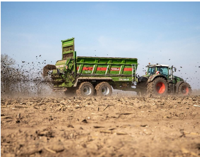
Bild: Der Universalstreuer TSW 6240 W mit dem Breitstreuwerk V-Spread kann Arbeitsbreiten bis 36 m realisieren.
