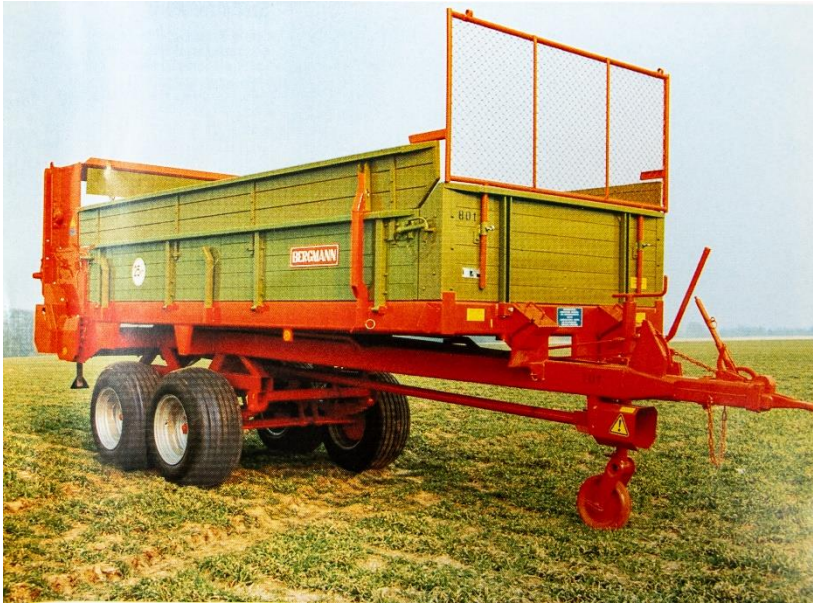
Bild: Der BERGMANN M 92 TA – hier mit Bordwandaufsätzen – war der erste Dungstreuer mit Tandem-Fahrwerk.
