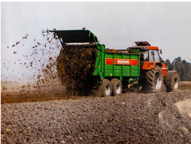
Bild: Mitte der 1990er wurde die erste Baureihe der BERGMANN Dungstreuer mit einem Aufbau aus Stahl gebaut – hier der M 800 mit
