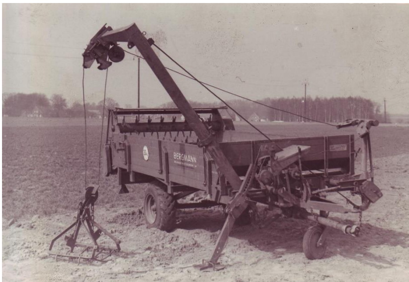
Bild: BERGMANN Dungstreuer M 70 mit dem Halbportal-Anbaulader L 100.
