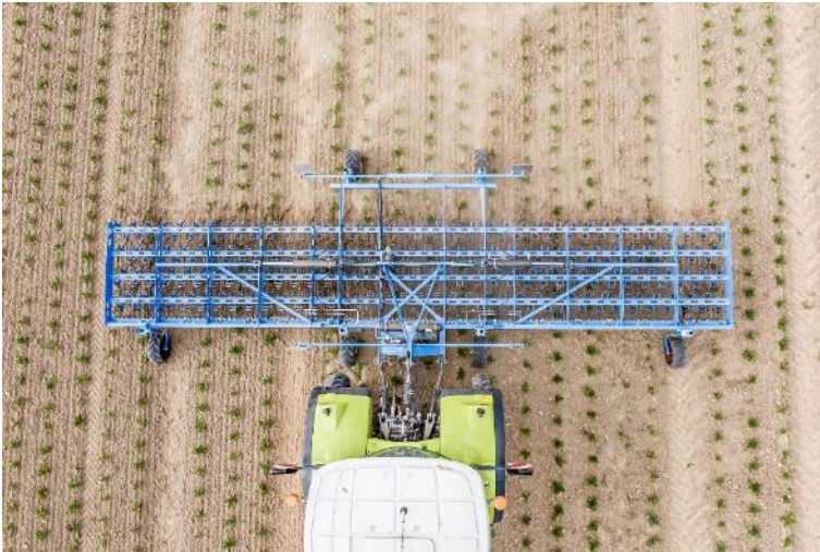
Bild 2: LEMKEN Striegel Thulit mit vier Balken und acht Reihen Striegelzinken.
