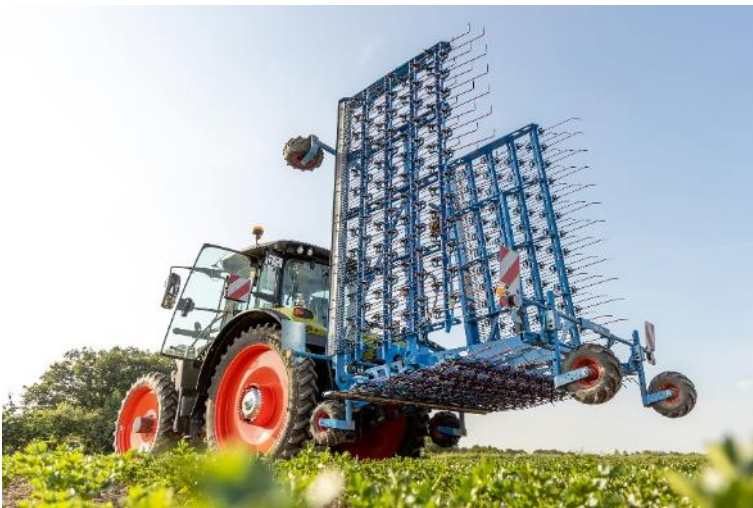
Bild 3: Transport des LEMKEN Thulit mit automatisch eingeklappten Zinken
