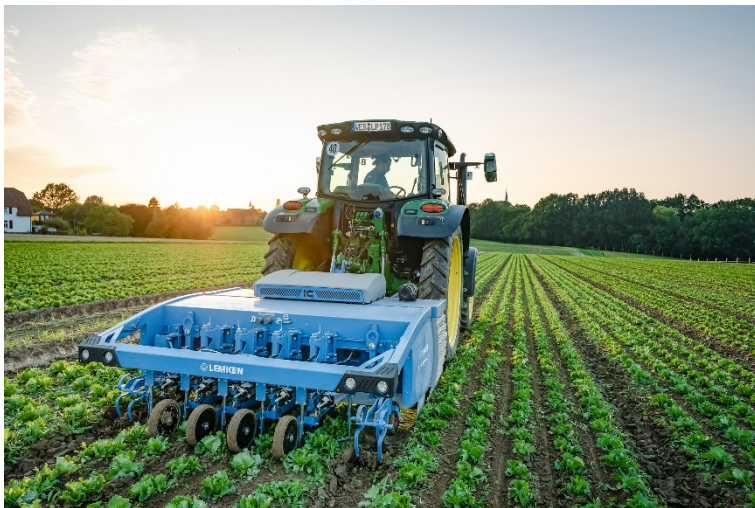
Bild 2: Automatische Hackmaschine IC-Weeder von LEMKEN
