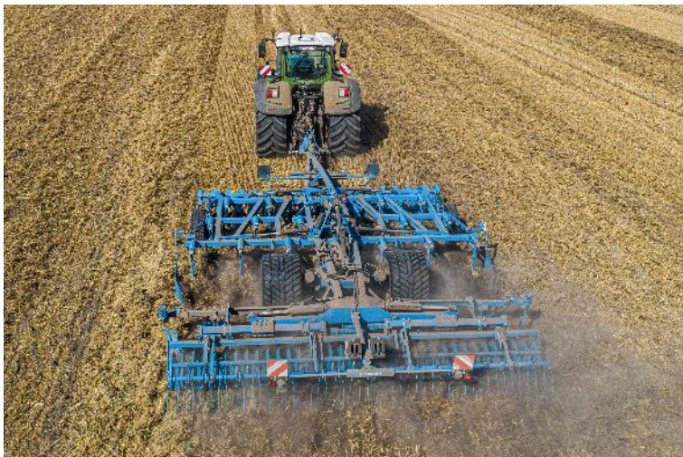
Bild 2: Aufgesattelter LEMKEN Grubber Karat 10 mit Scheibenvorläufer
