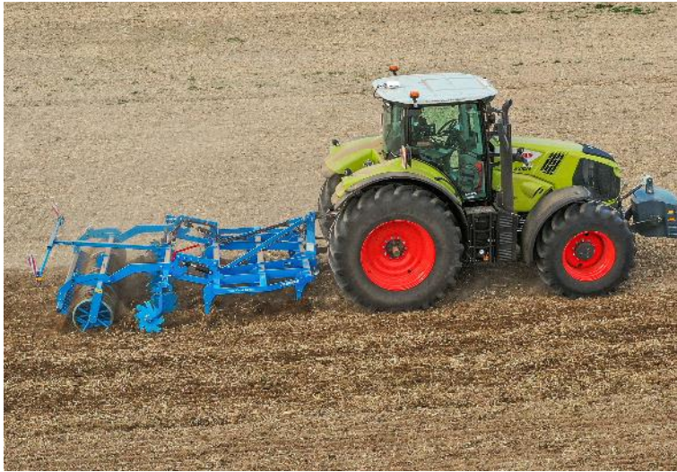
Bild 1: Angebauter LEMKEN Grubber Karat 10 mit Nivellierscheiben
