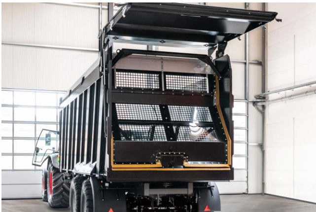
Krampe_003 Das Schiebeschild ist vollflächig in einer Gitteroptik ausgeführt
