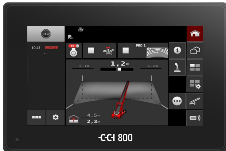
Bild: Über das CCI 800 Bedienterminal können die Einstellungen der Maschine vorgenommen werden.
